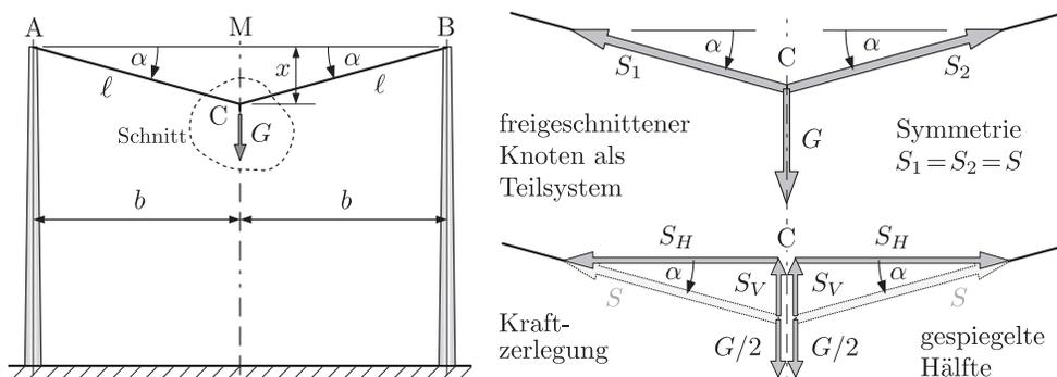
**Abbildung 1.3:** Frei hängende Verkehrsampel mit freigeschnittenem Knoten als Teilsystem
