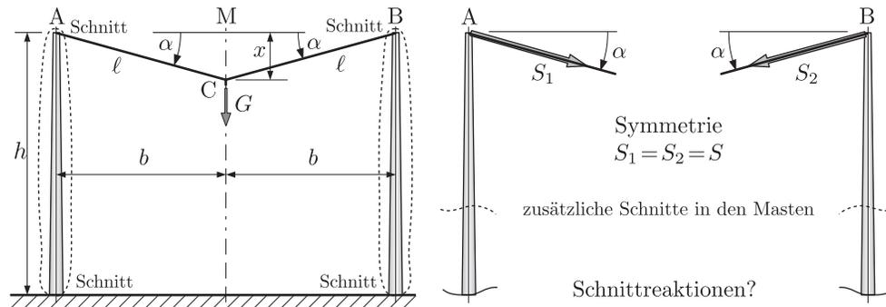
**Abbildung 1.5:** Frei hängende Verkehrsampel mit freigeschnittenen Masten
