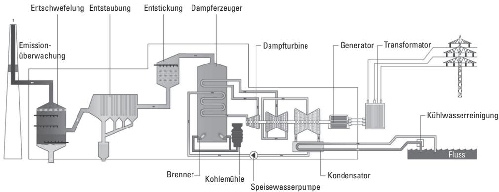
Abbildung 1.4: Unit Operations am Beispiel eines Kohlekraftwerks (EnBW)
