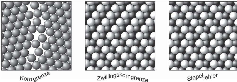
Abbildung 1.11: Zweidimensionale Kristallbaufehler
