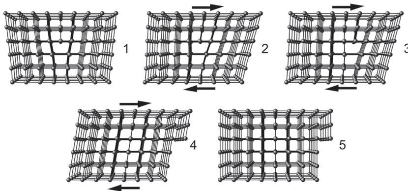
**Abbildung 1.10:** Mechanismus der plastischen Verformung durch Versetzungsbewegung
