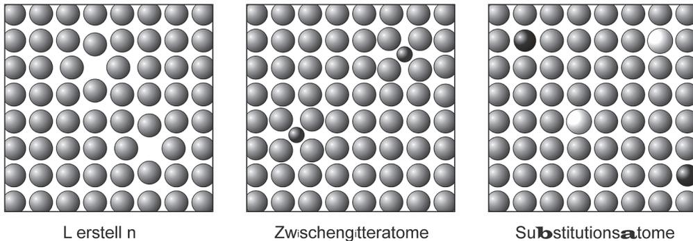
**Abbildung 1.8:** Nulldimensionale Kristallbaufehler
