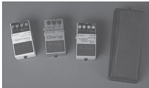
Abbildung 1.3: Vier übliche, von Gitarristen oft benutzte, elektronische Effekte (von links nach rechts): Delay, Chorus, Verzerrer, Wah-Wah
