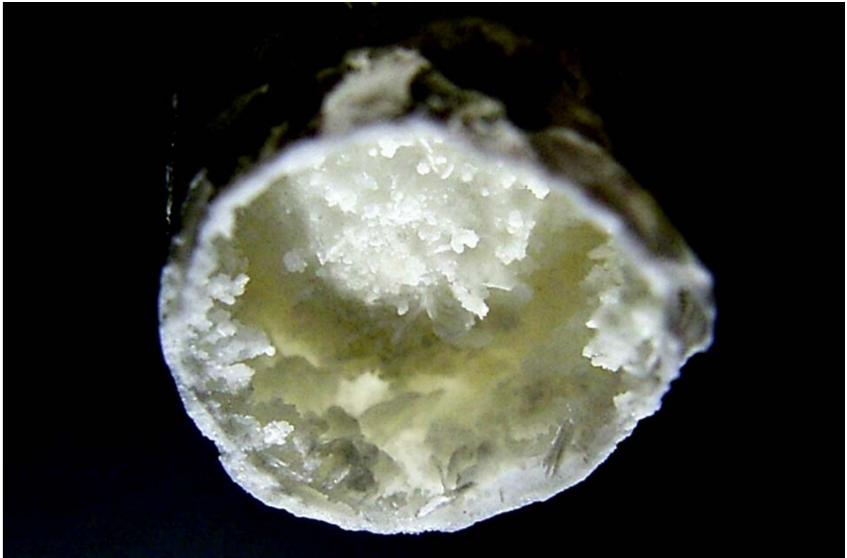
Bilder 4.1.1 R und S: Sinterröhrchen (Durchmesser: 5 bis 8 mm), die sich im Verlauf von ca. 18 Jahren an einer Betondecke gebildet haben sowie Detail (Ansicht von unten), Juli 1993
