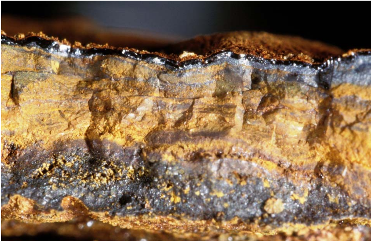
Bild 4.3.1 B: Deckschicht einer Graugussleitung aus Hannover DN 600, 1977, 5 x 7,5 mm. Die tiefschwarze Schicht besteht überwiegend aus Magnetit.
