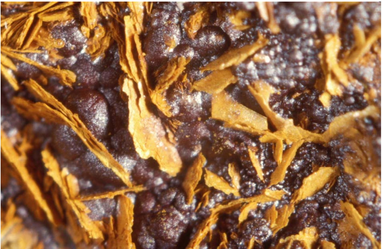
Bild 4.3.1 G: wie F, Siderit mit oxidiertem green rust, 2 x 3 mm
