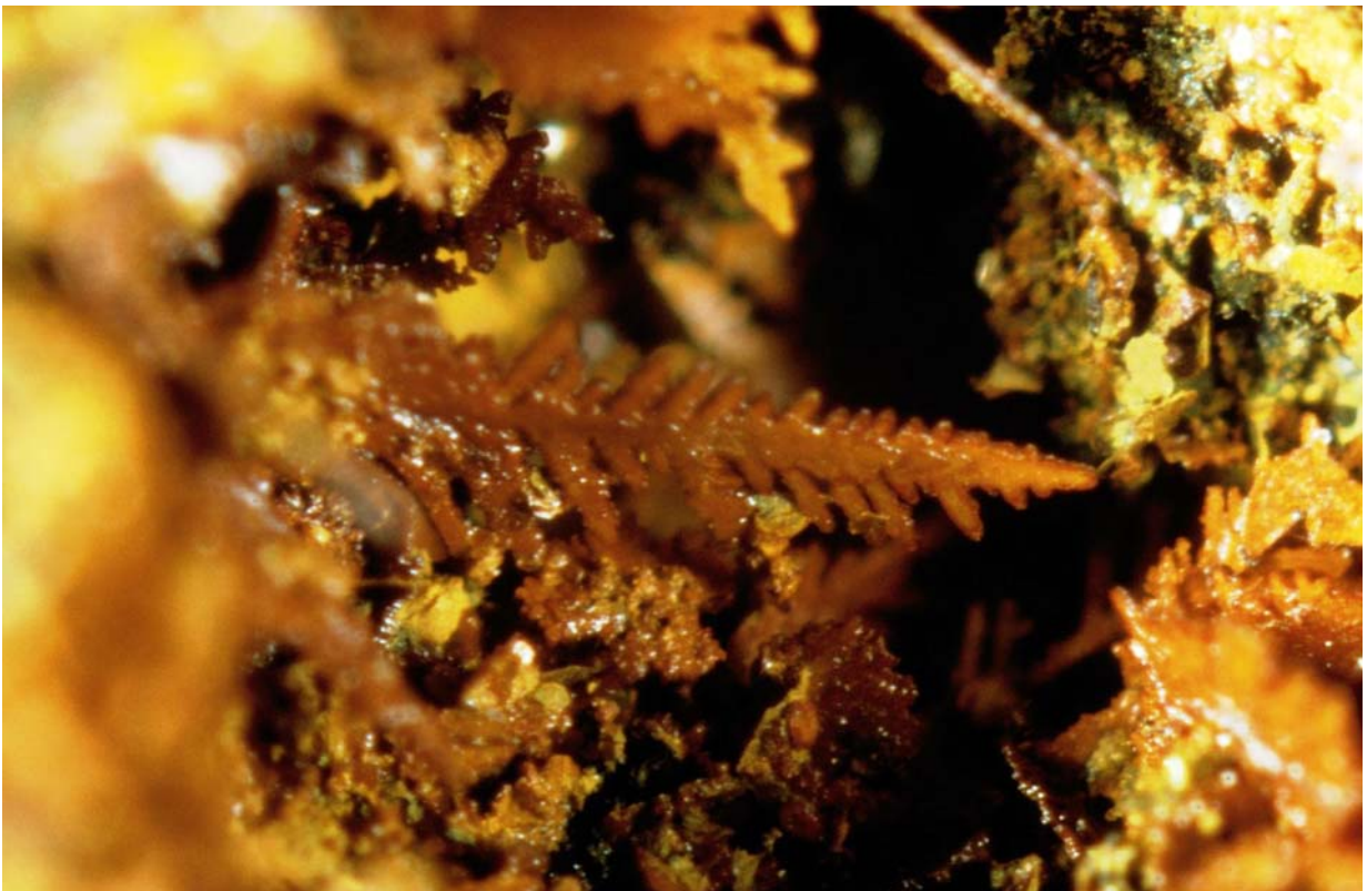
Bild 4.3.1 I: Dendritische Bildung (schwefelhaltig), Graugussleitung, Hannover DN 500, 1979, 1,7 x 2,5 mm
