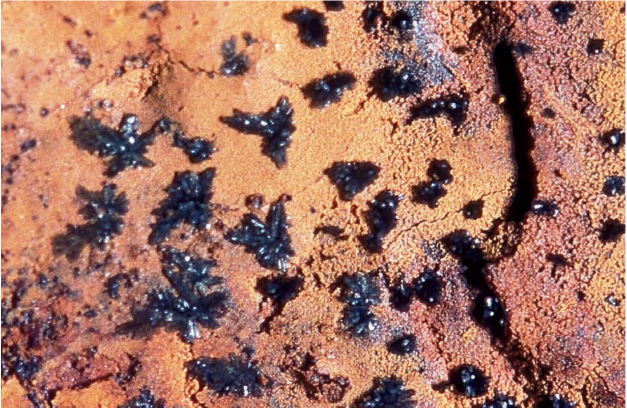
Bild 4.3.1 H: Vivianit nach Phosphatdosierung, Hannover DN 200, 1984, 1,7 x 2,5 mm. Vivianit, in frischem Zustand farblos, wird langsam blau und dann dunkelgrün.
