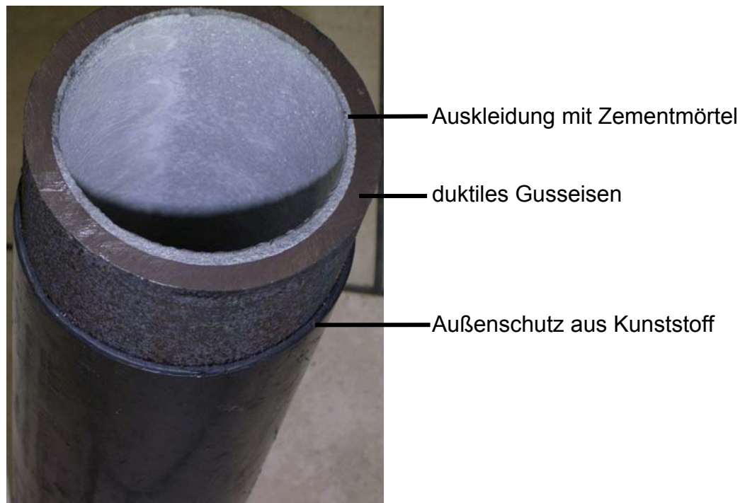
Bild 4.3.1 A: modernes Rohr aus Duktulguss, DN 100
