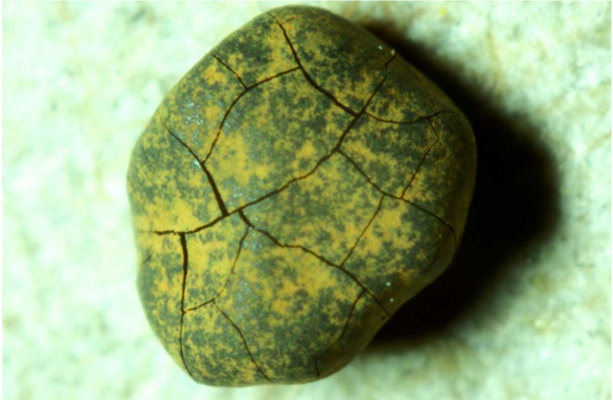
Bild 4.3.1 B: Filterkorn aus dem Wasserwerk Elze-Berkhof der Stadtwerke Hannover AG, 1996, 2 x 3 mm. Die Schrumpfungsrisse sind beim Trocknen entstanden.
