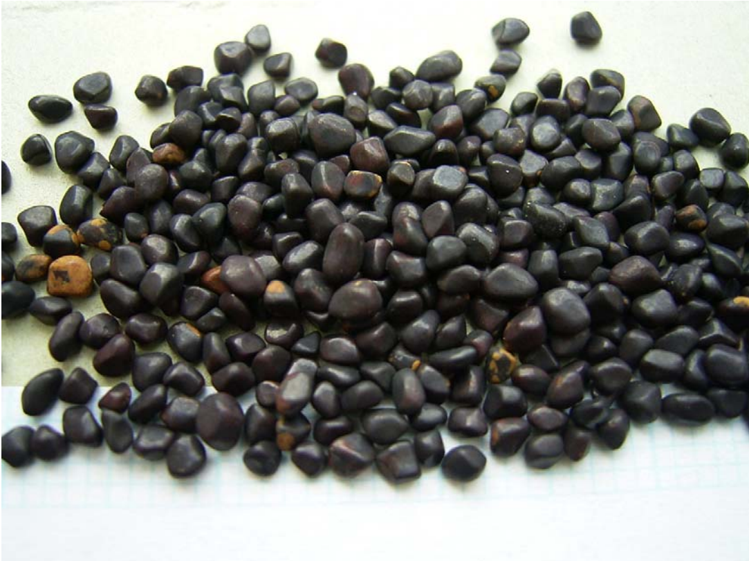
Bild 4.3.1 E: Filterkies aus einem Grundwasserwerk, 1982, 26 x 34 mm
