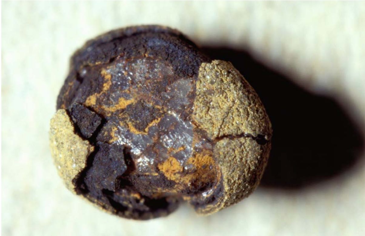
Bild 4.3.1 J: Filterkies aus einem Grundwasserwerk, 1996 (ca. 17 Jahre im Einsatz), 3,3 x 5 mm
