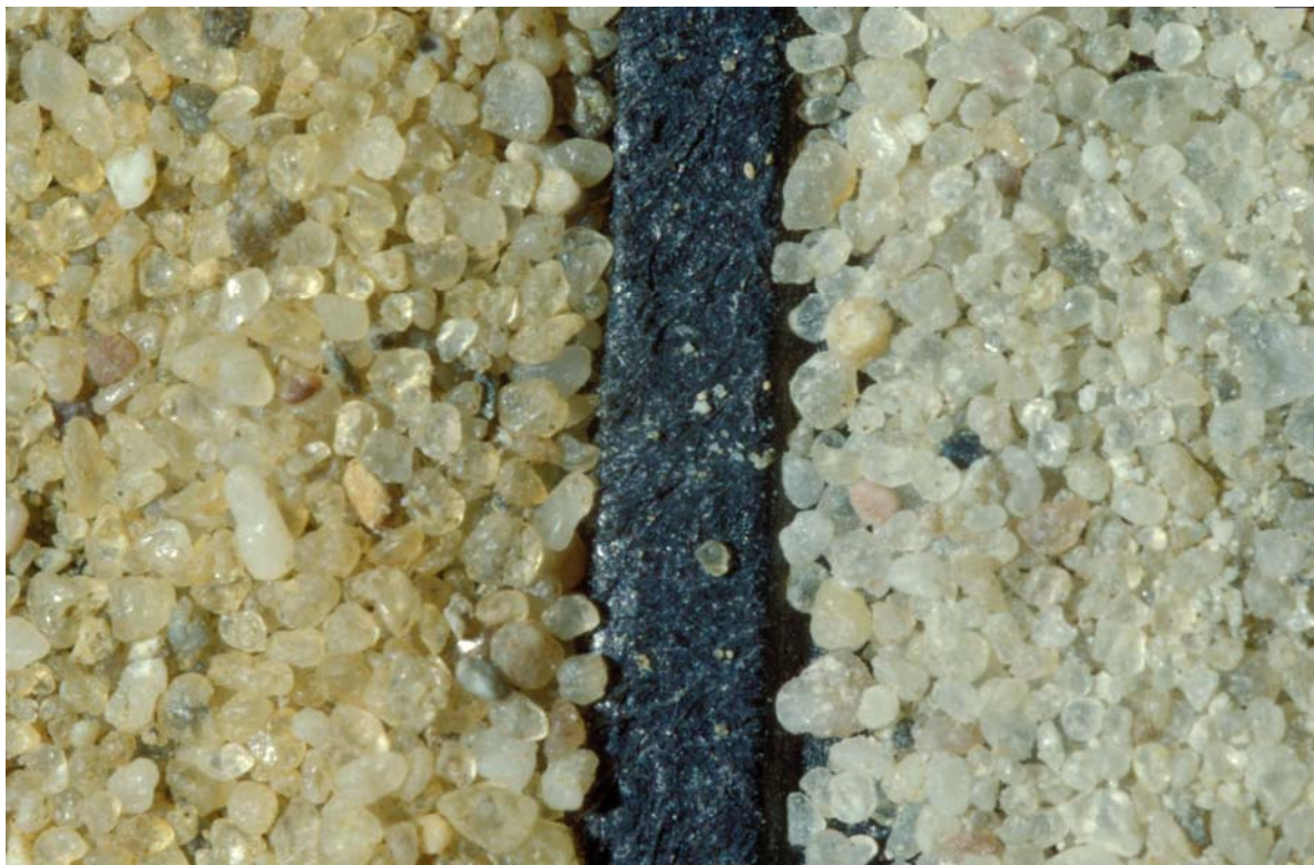
Bild 4.3.1 C: Unterirdische Wasseraufbereitung im Feldversuch: Gegenüberstellung von brunnennahem (links) und brunnenfernem Aquifermaterial (rechts)
