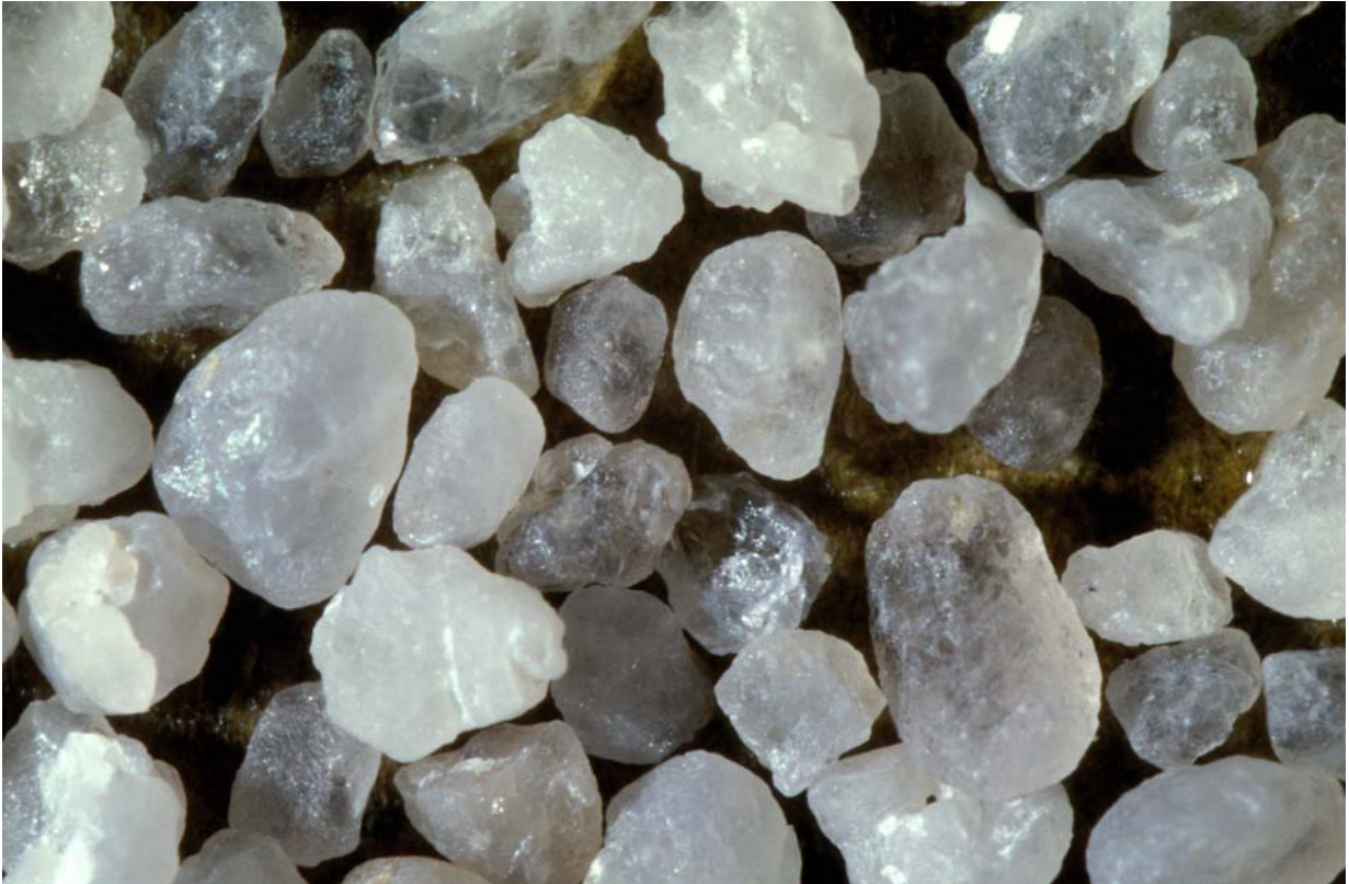
Bild 4.3.2 B: Kies, Filter 5, frisch, In Betrieb: 21.04.1985, 5 x 7,5 mm (FUHR_03) (die Klammerausdrücke nehmen Bezug auf die Grafiken am Ende des Abschnitts)
