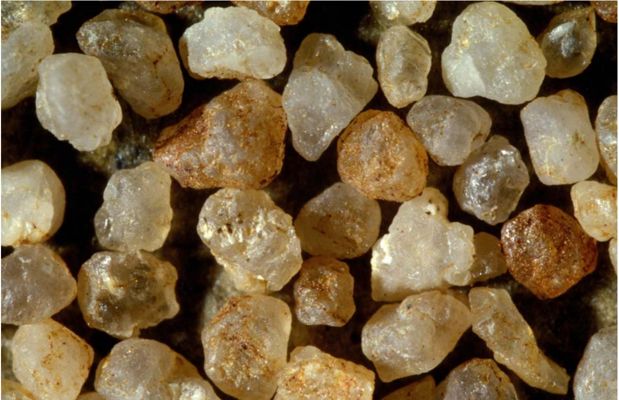
Bild 4.3.2 F: Kies, 65 Tage alt 5 x 7,5 mm, Elimination: \text{NH}_4^+ : 100 %, \text{Mn}^{2+} : 50 % (FUHR_05)
