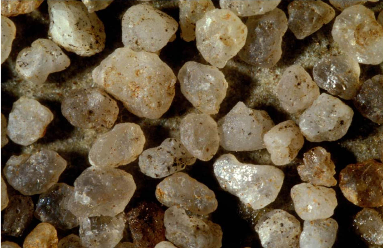
Bild 4.3.2 H: Kies, 82 Tage alt, 5 x 7,5 mm Elimination: \text{NH}_4^+ : 100 %, \text{Mn}^{2+} : 100 % (FUHR_06)
