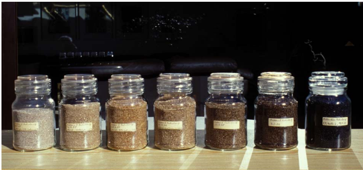
Bild 4.3.2 A: "Galerie", Filterkies aus dem Filter 5 des Wasserwerks Fuhrberg während der Einarbeitung. Probenahme zu den Zeitpunkten 08.05.85 / 30.05.85 / 25.06.85 / 12.07.85 / 26.09.85 / 03.02.86 / letztes Gefäß: Kies von Filter 9 nach einer Betriebszeit von vier Jahren.
