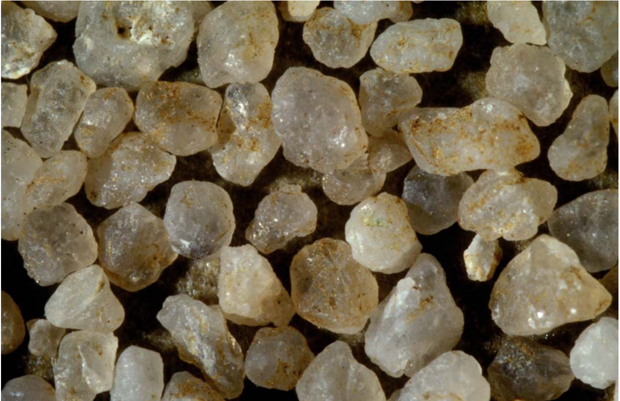
Bild 4.3.2 D: Kies, 39 Tage alt, 5 x 7,5 mm, Elimination: \text{NH}_4^+ : 100 %, \text{Mn}^{2+} : 0 % (FUHR_04)
