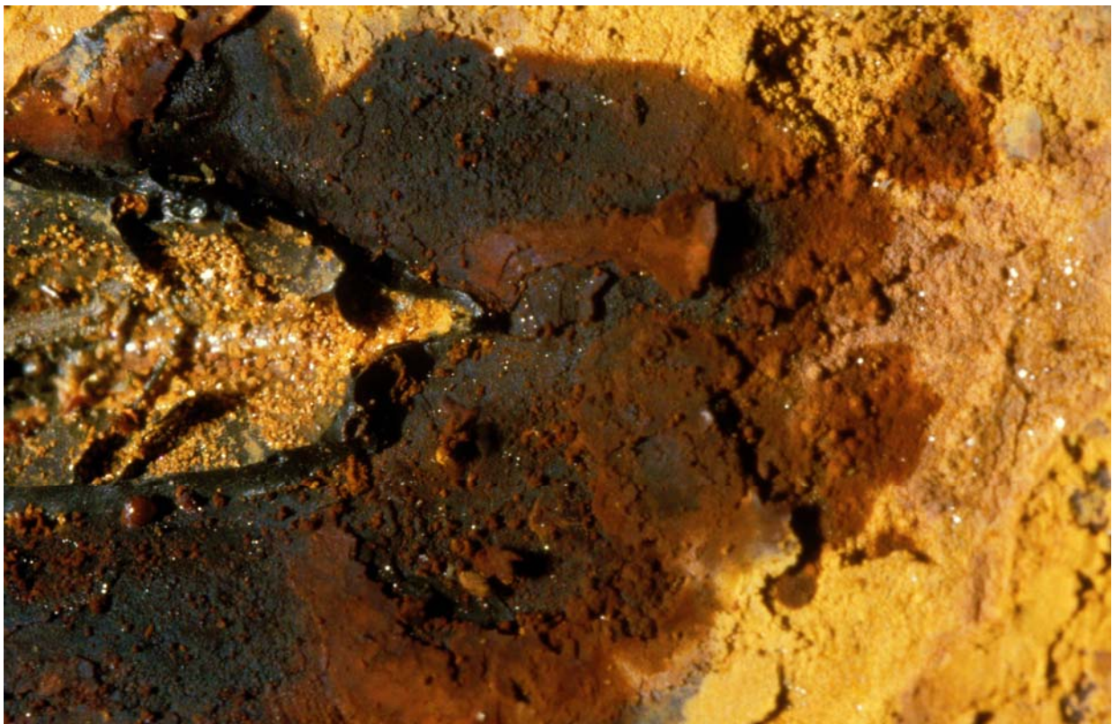
Bilder 4.4.1 D und E: Getrocknete \text{FeCl}_2 -Lösung, Bild D: mit Blasen, 1,7 x 2,5 mm, Bild E: 5 x 7,5 mm
