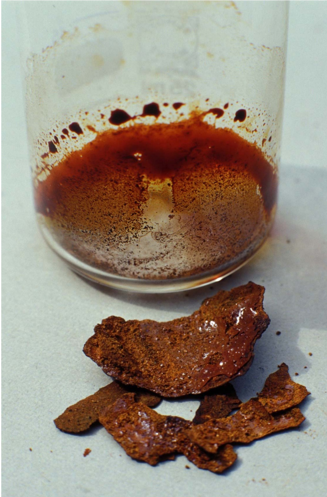
Bild 4.4.1 C: "FeCl 2 -Pustel". Im Becherglas: benzollösliche Anteile, davor: extrahierte Splitter der Pustelwandung
