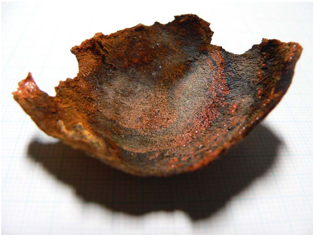
Bilder 4.4.1 A und B: "FeCl 2 -Pustel" außen und innen. In Bild 4.4.1 A kann man die im Text erwähnten Mikrorisse erkennen.
