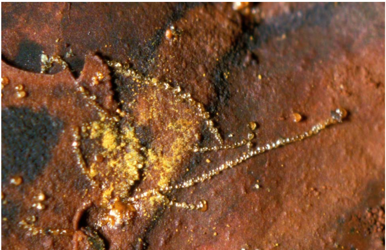
Bilder 4.4.4 A und B: Schwefel in einer Transportleitung in Hannover, DN 800, Grauguss, 1980, 1,7 x 2,5 mm (beide)
