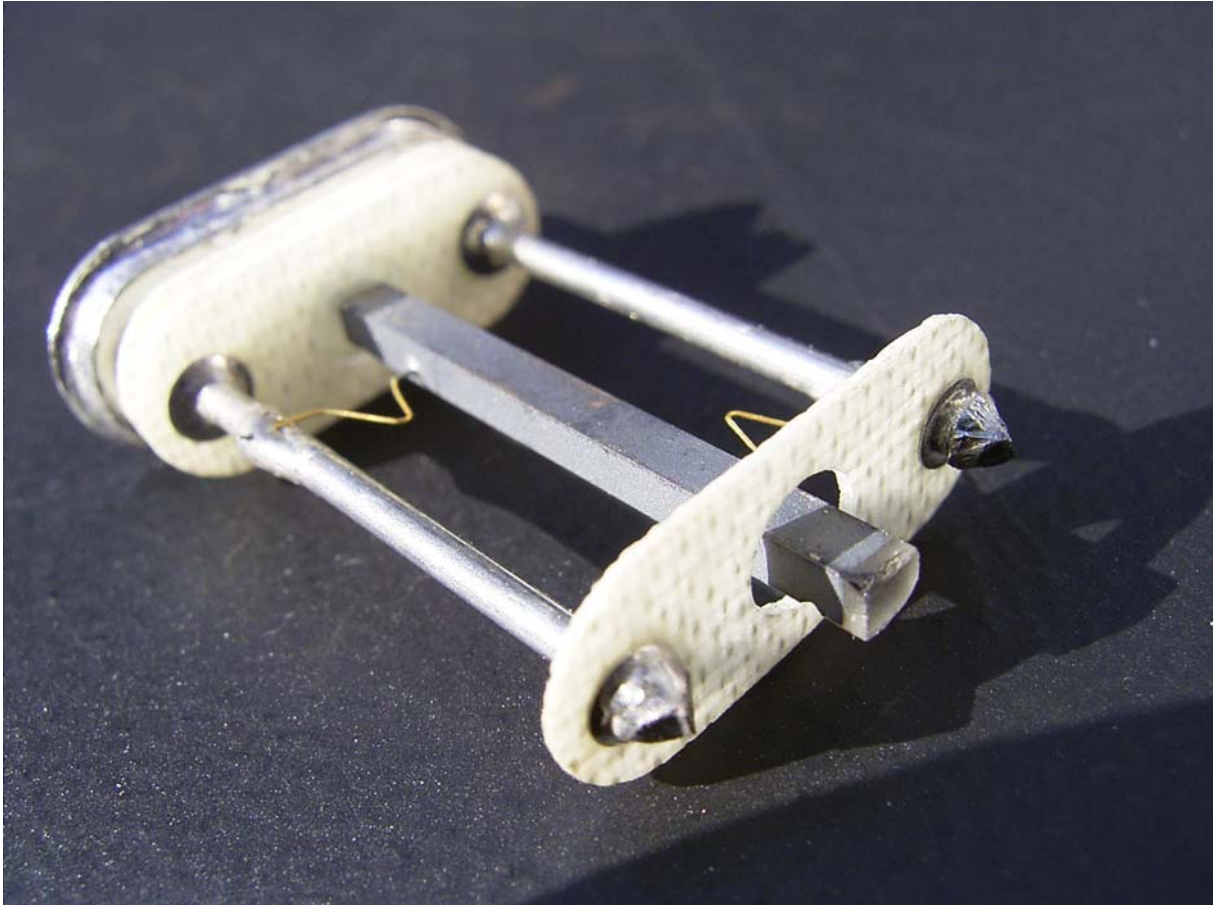
Bild 4.4.7 M: Schwingquarz älterer Bauart, Länge des Bauteils: 35 mm
