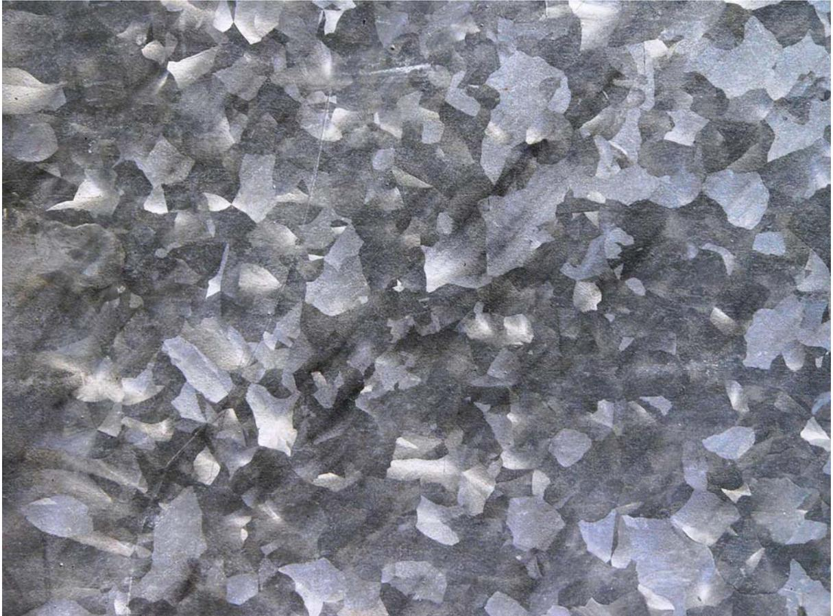
Bild 5.3.18 B: Verzinktes Stahlblech, Breite ca. 50 cm
