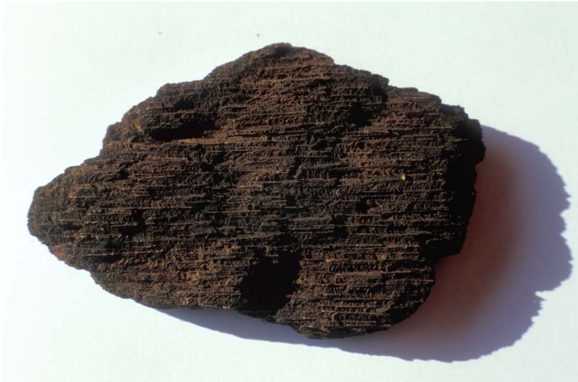
Bild 5.3.1 A: "Aluminium-Verockerungsprodukt", Rückseite, Brunnen1, Fuhrberg, 1969, 73 x 110 mm
