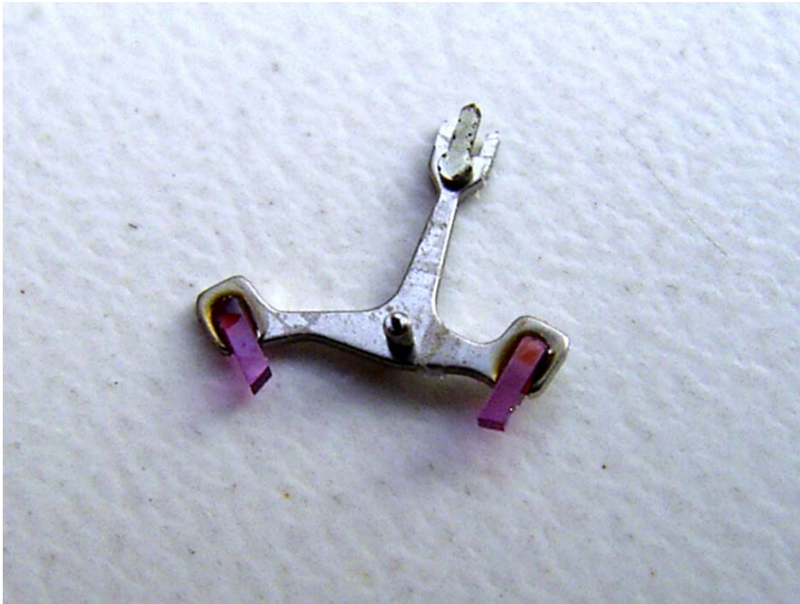
Bild 5.3.1 L: Anker einer Armbanduhr mit Rubin-Paletten (mittlerer Abstand der Paletten: ca. 3 mm).
