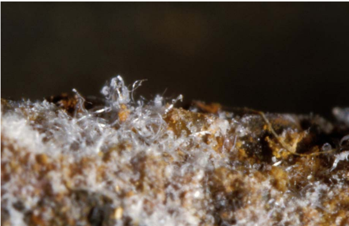
Bild 5.3.1 I: wie H, Trinkwasserleitung DN 100, 1979, 2 x 3 mm.
