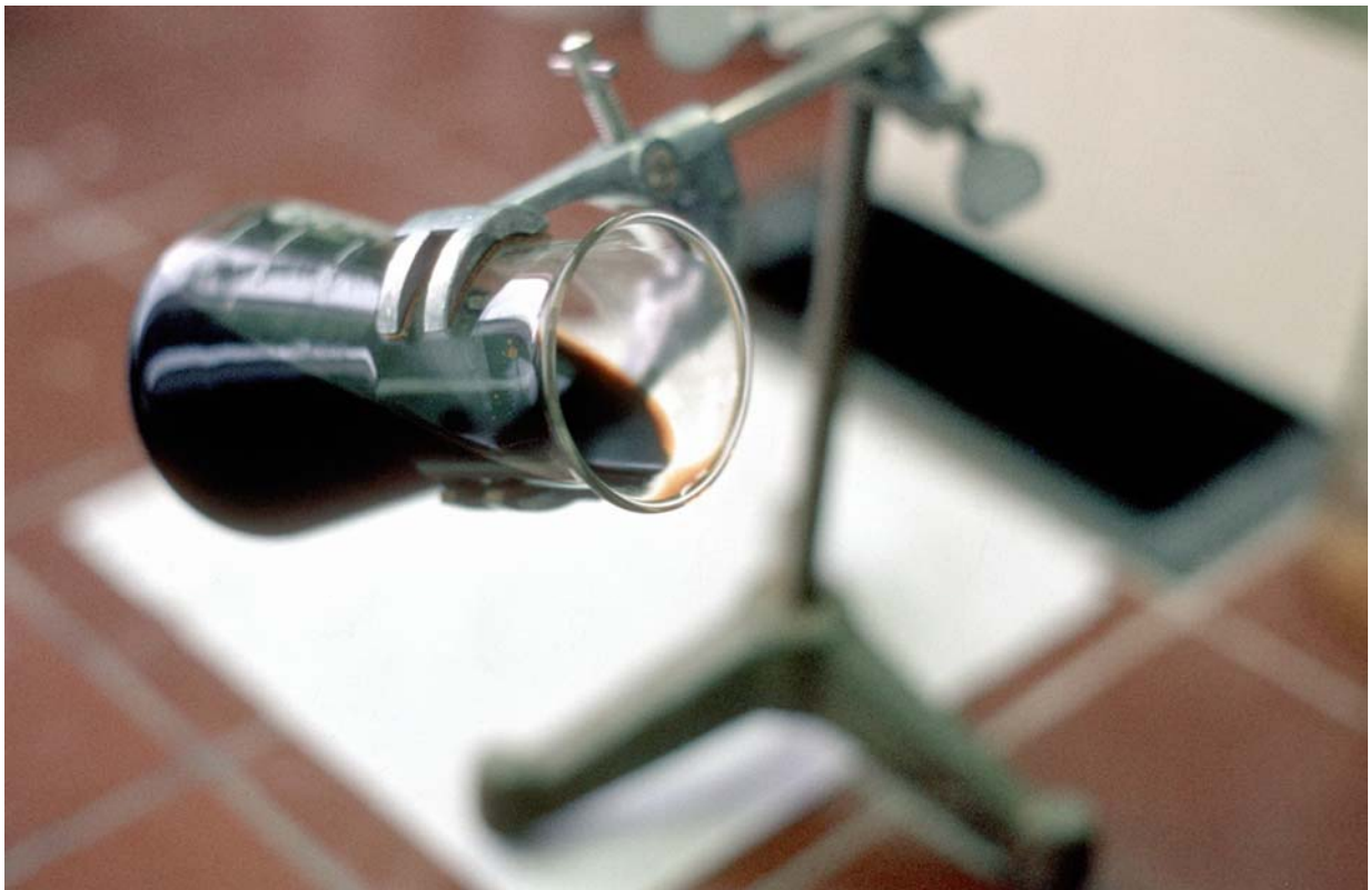
Bild 6.3.4 K: Eluat aus der Adsorberharzanlage, Wasserwerk Fuhrberg, 1982
