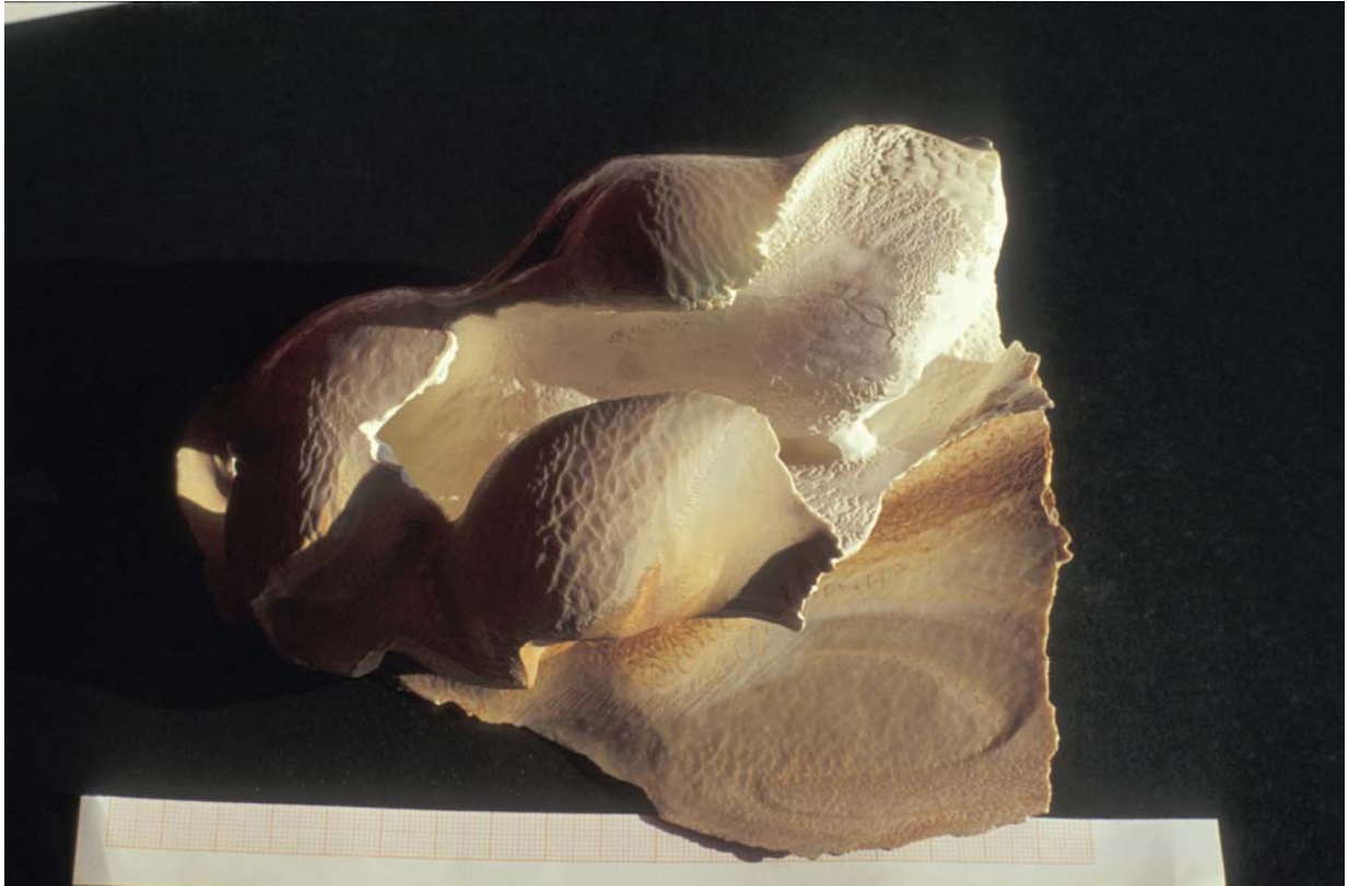
Bild 7 B: Calcit von der Dosierstelle für Kalkhydrat an einer Flockungsanlage
