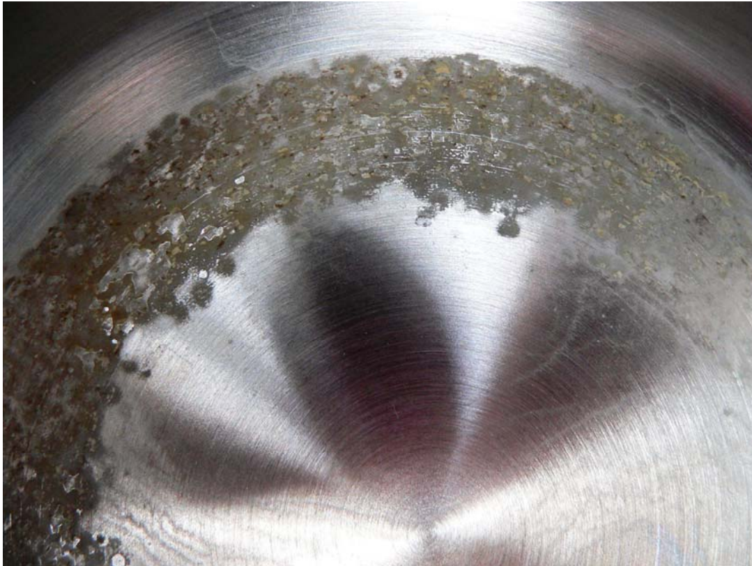
Bild 7 N: Calcitausscheidung durch Hitze in einem Wassertopf
