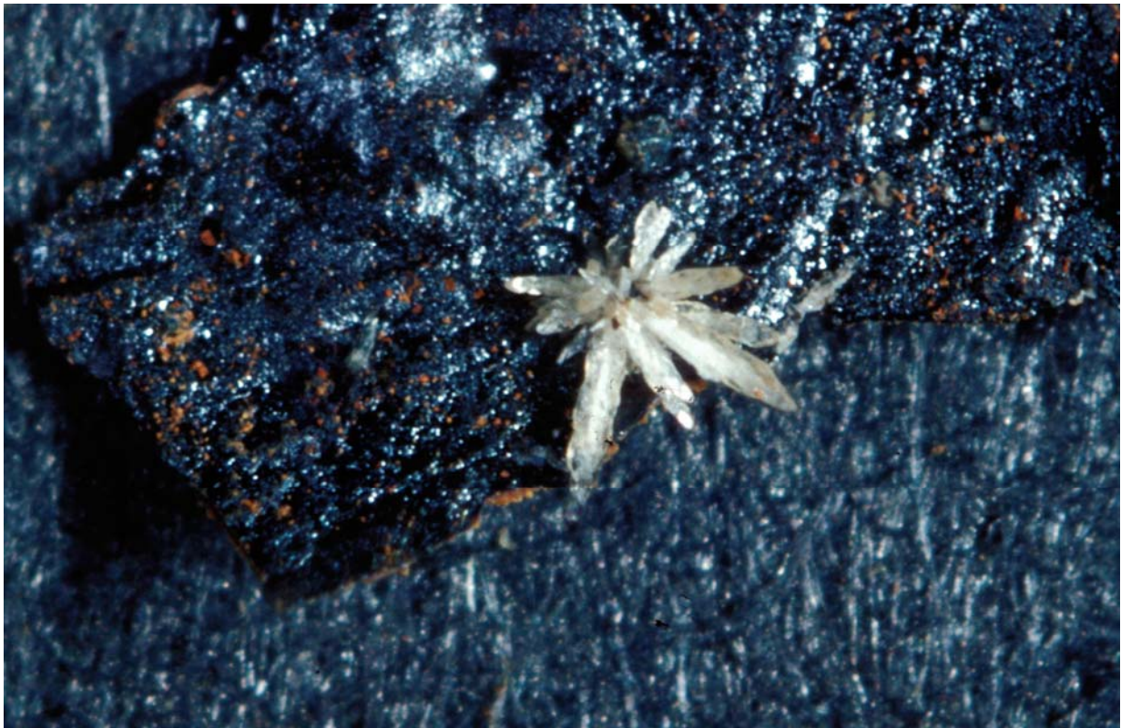
Bild 7 A: Calcit im Inneren einer Bitumenblase in einem Graugussrohr, August 1979, 2 x 3 mm
