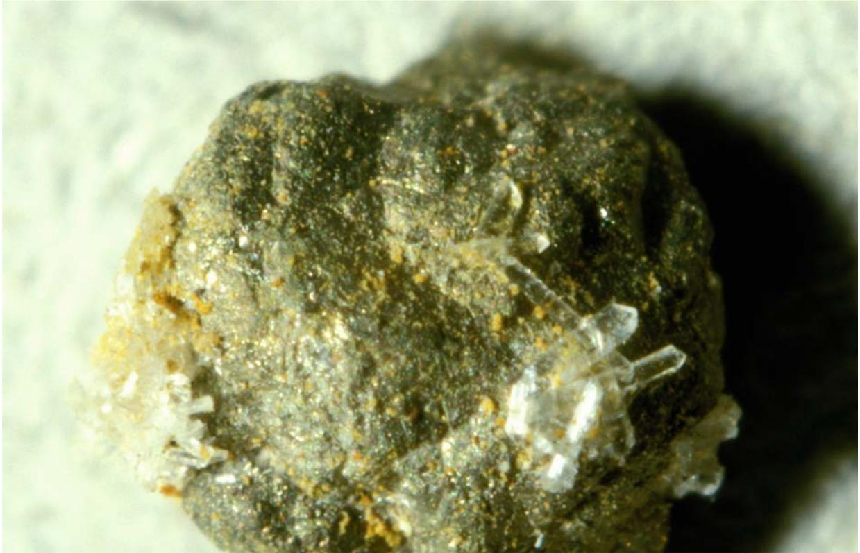
Bild 4.3.1 A: Pyrit mit Gips, Aufschlussbohrung 3, Fuhrberger Feld, 1983, Tiefe: 22,5 m, 1,7 x 2,5 mm
