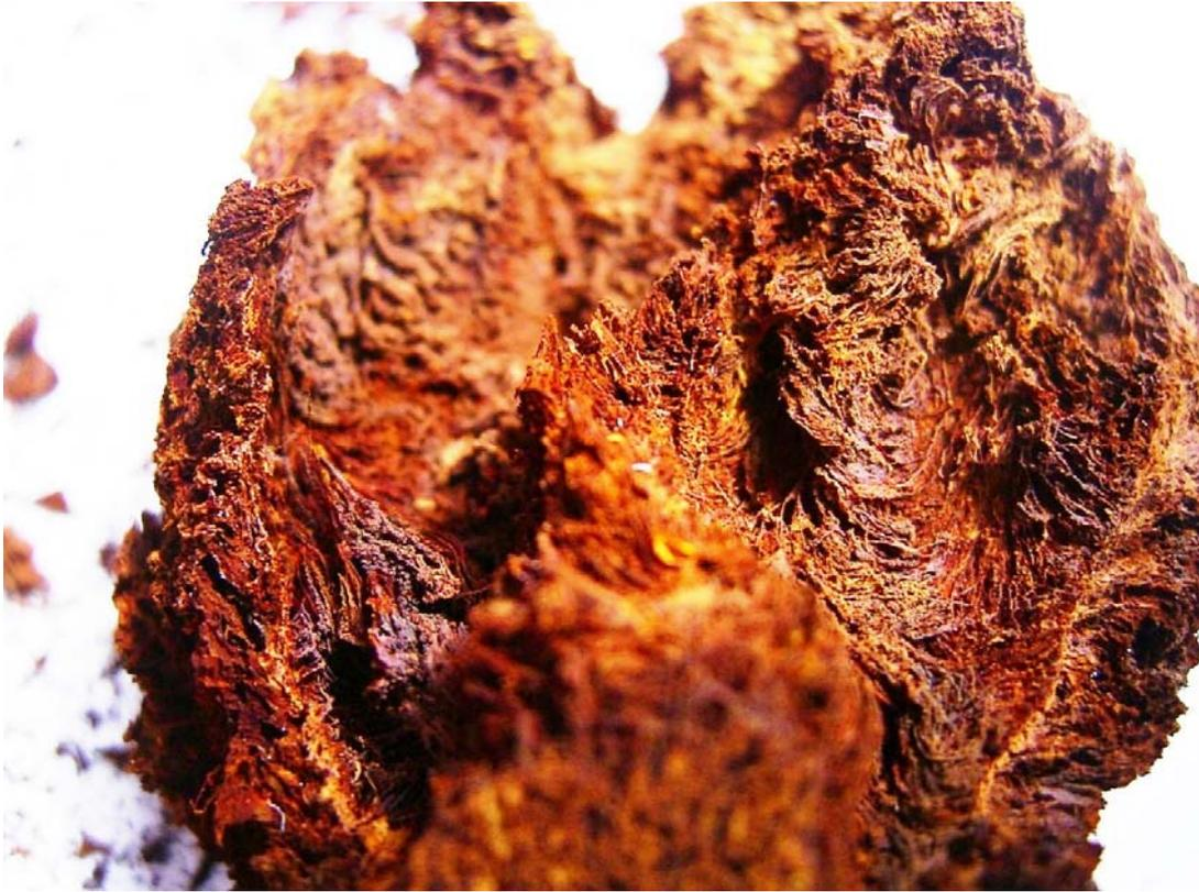
Bild 4.3.1 S: Verockerungsprodukt, 2007, 26 x 35 mm
