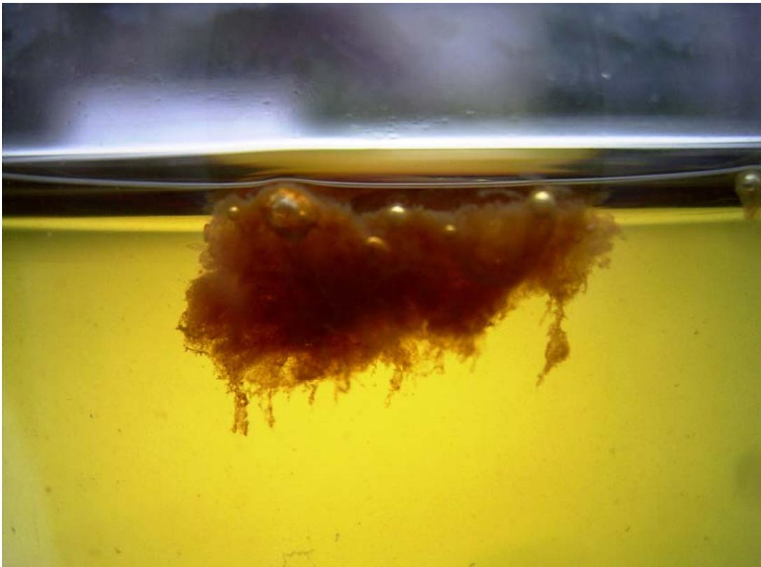
Bild 4.3.1 T: wie S, säureunlöslicher organischer Rückstand, 15 x 20 mm (extrazelluläre polymere Substanz, "EPS")
