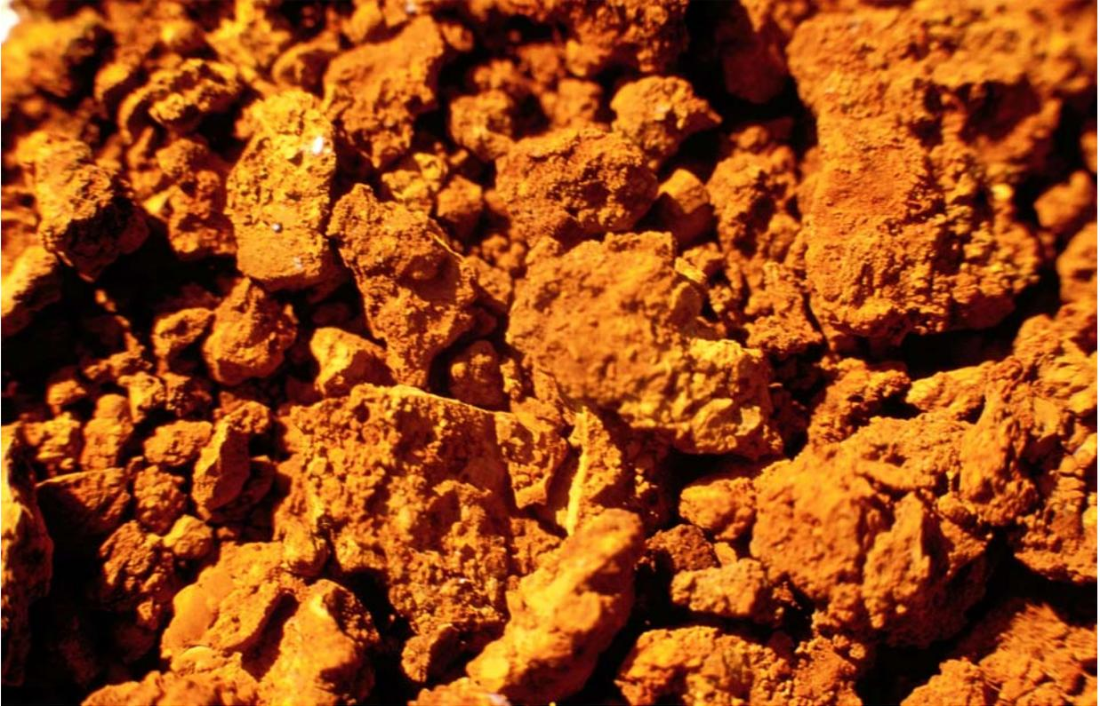
Bild 4.3.1 Q: Verockerungsprodukt aus Brunnen 4, Fuhrberg, 1982, 40 x 60 mm
