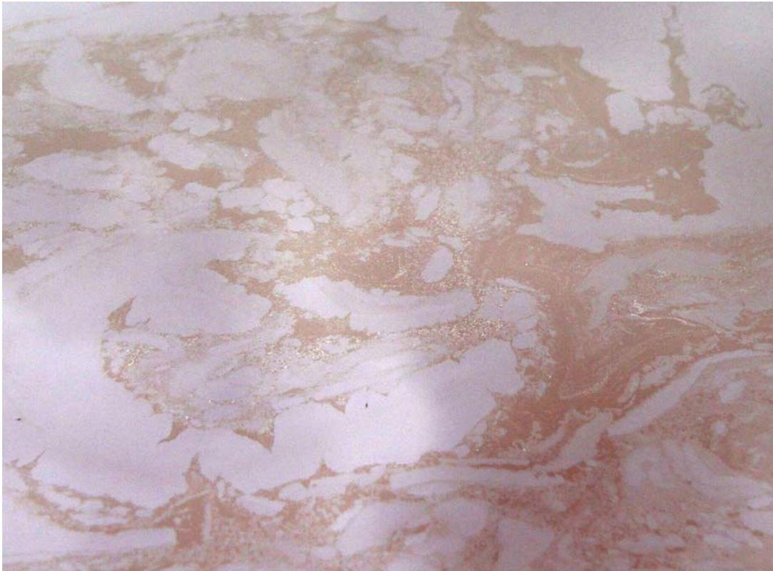
Bild 4.3.1 X: Eisen(III)-Oberflächenfilm
