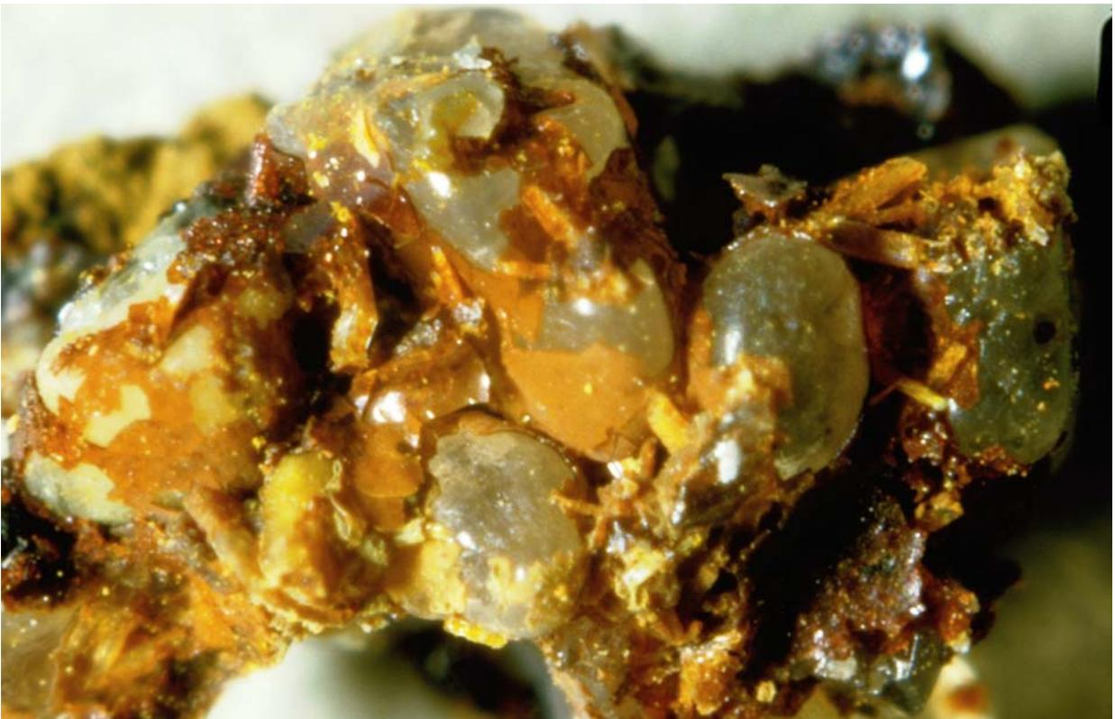
Bild 4.3.1 H: wie F, Oxidationsprodukt hauptsächlich Eisen(III)-oxidhydrat, 1,7 x 2,5 mm
