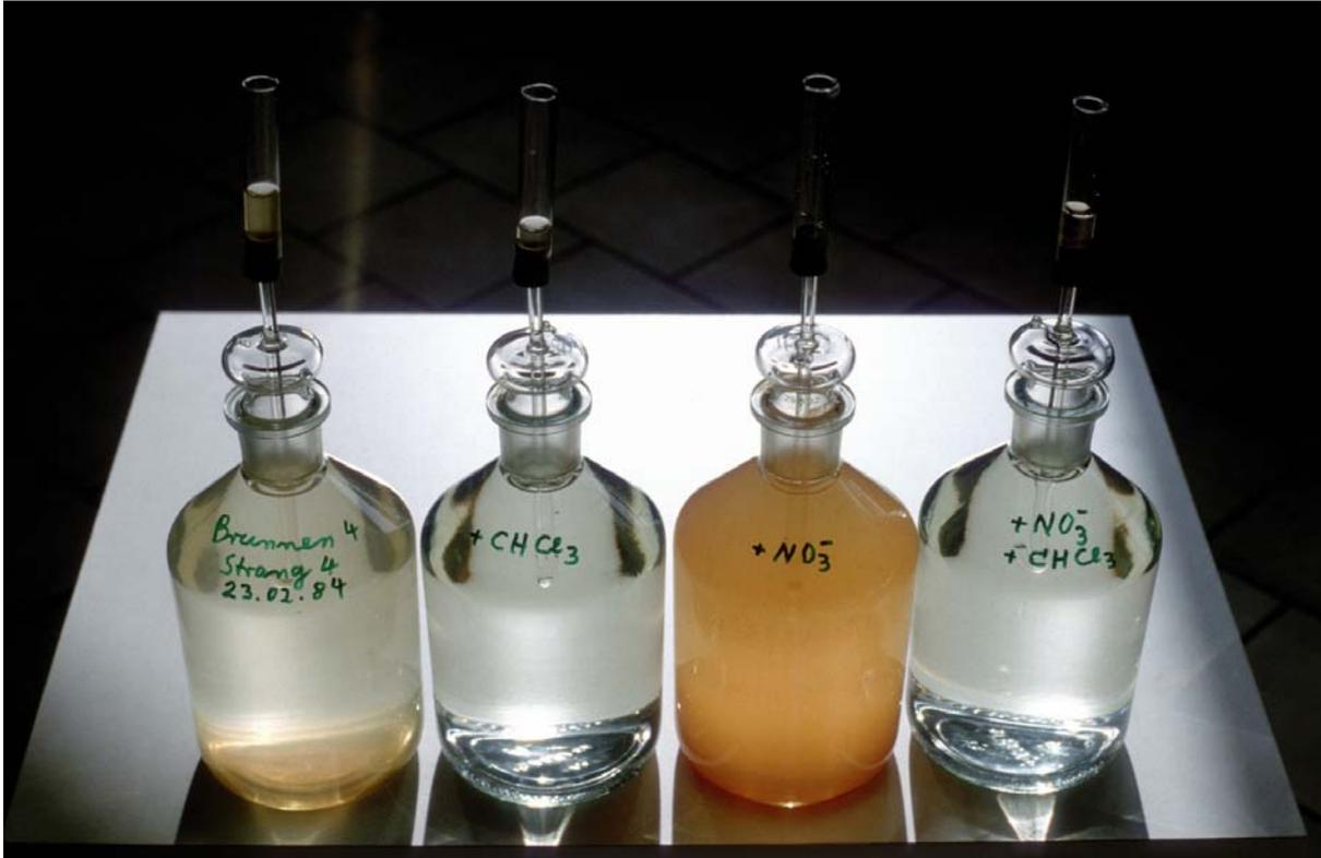
Bilder 4.3.1 J: "Nitratverockerung" im Labor. Die Zugabe von Chloroform zum Versuchsansatz verhindert das Bakterienwachstum bzw. die Eisenoxidation perfekt.
