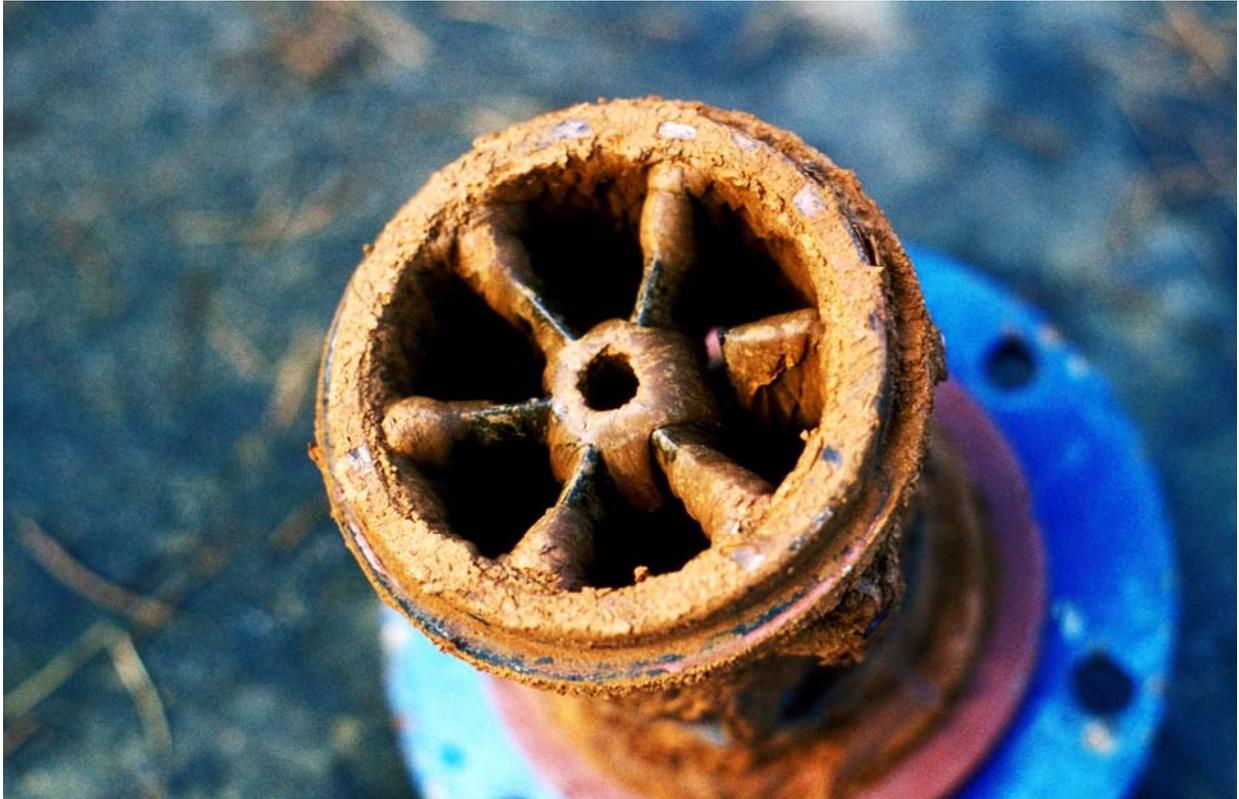
Bild 4.3.1 O: Verockertes Einbauelement
