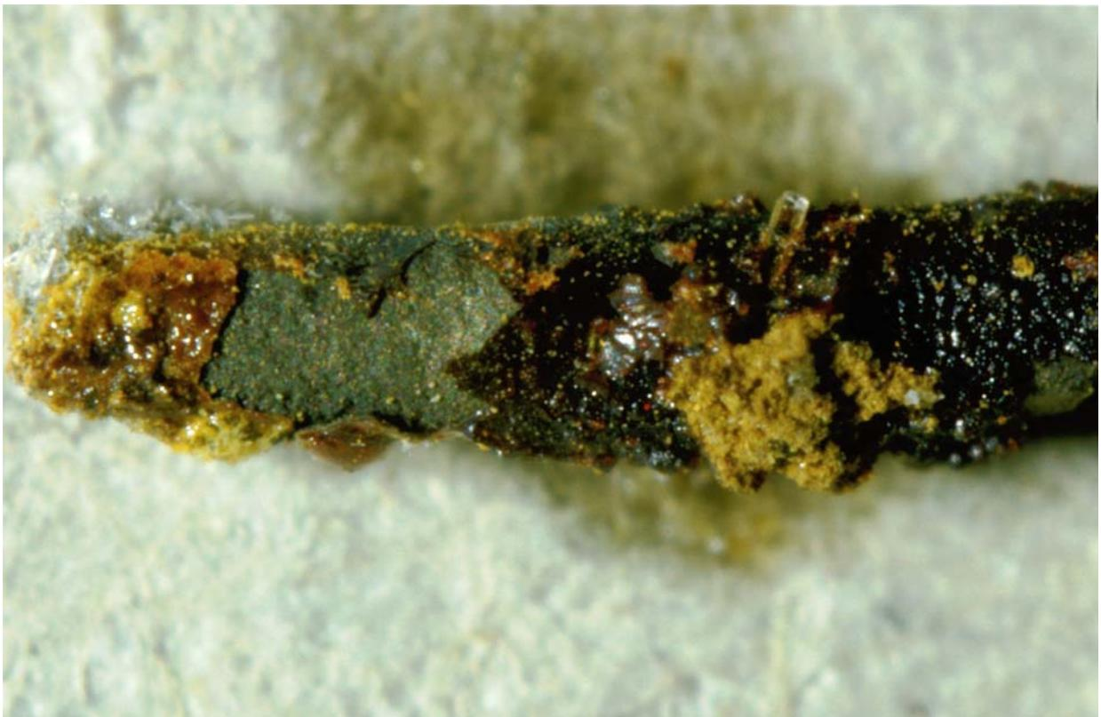
Bild 4.3.1 F: Eisensulfid, oxidiert, Aufschlussbohrung 3, Fuhrberger Feld, 1983, 22,5 m Tiefe, 1,7 x 2,5 mm
