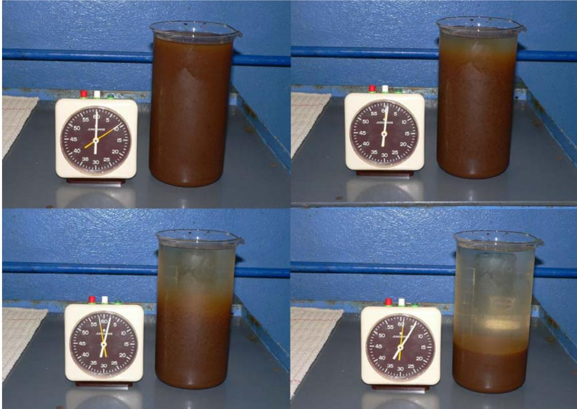
Bild 4.3.1 H: Schlamm-Sedimentation
