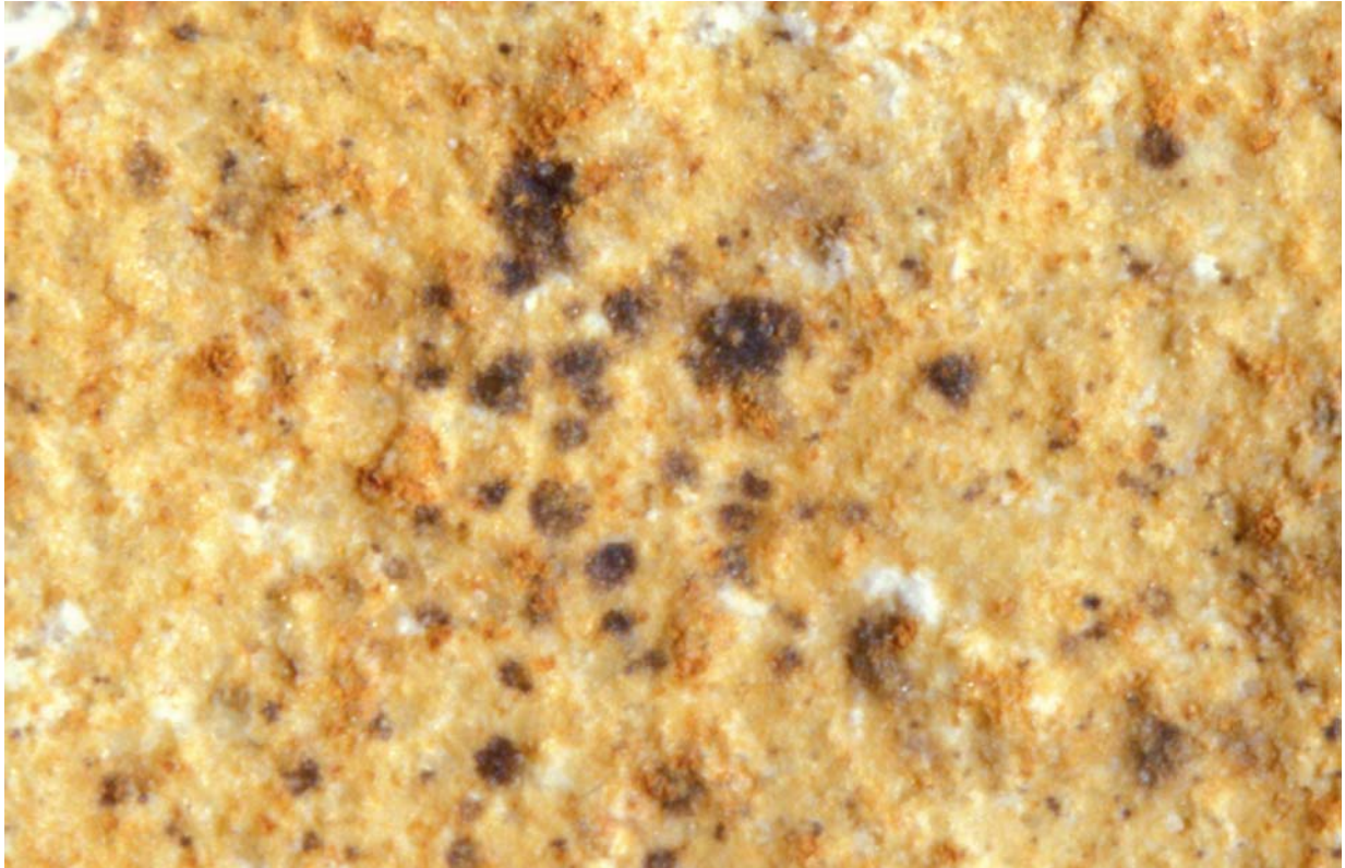
Bild 4.3.2 B: Abscheidung von Eisen- und Manganoxiden, Feldversuch, Bohrung 1, Tiefe 8 m, 2 x 3 mm
