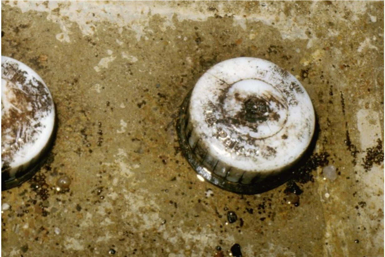
Bild 4.3.2 B: Filterdüse nach Reinigungsversuch, 1982
