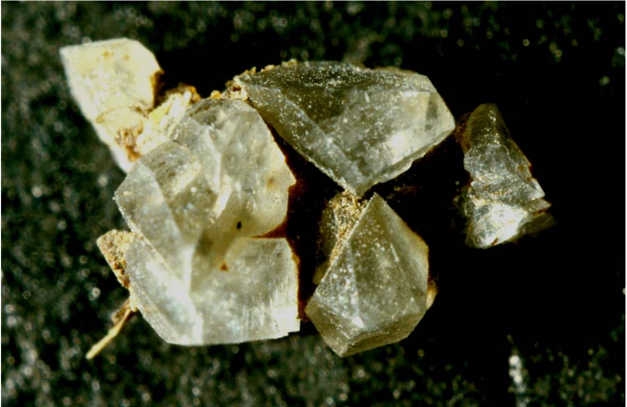
Bild 4.4.6 D: Struvit, Gülleaufbereitungsanlage, TU Hannover, 1984, 5 x 7,5 mm
