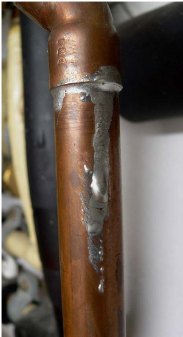
Bild 5.3.11 A: Lötstelle mit Weichlot, drei Jahre alt ("suboptimal")
