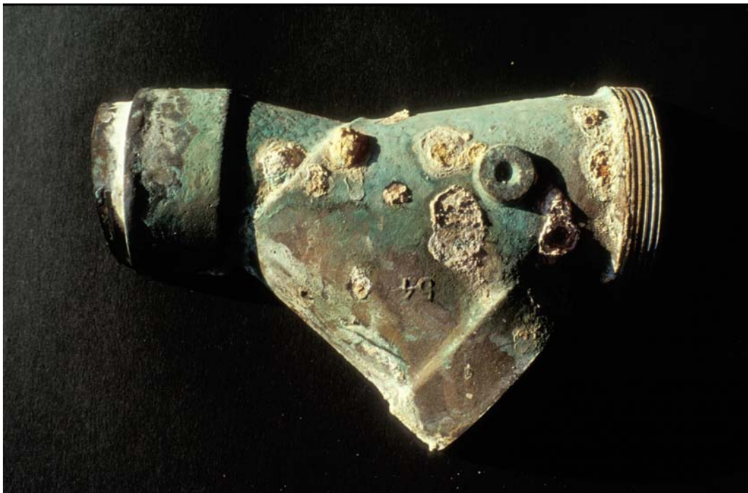
Bild 5.3.11 K: Messingarmatur, die durch Entzinkung undicht wurde. Das durch das scheinbar massive Metall hindurchsickernde Wasser verdunstet und bildet dabei weiße Ausblühungen.
