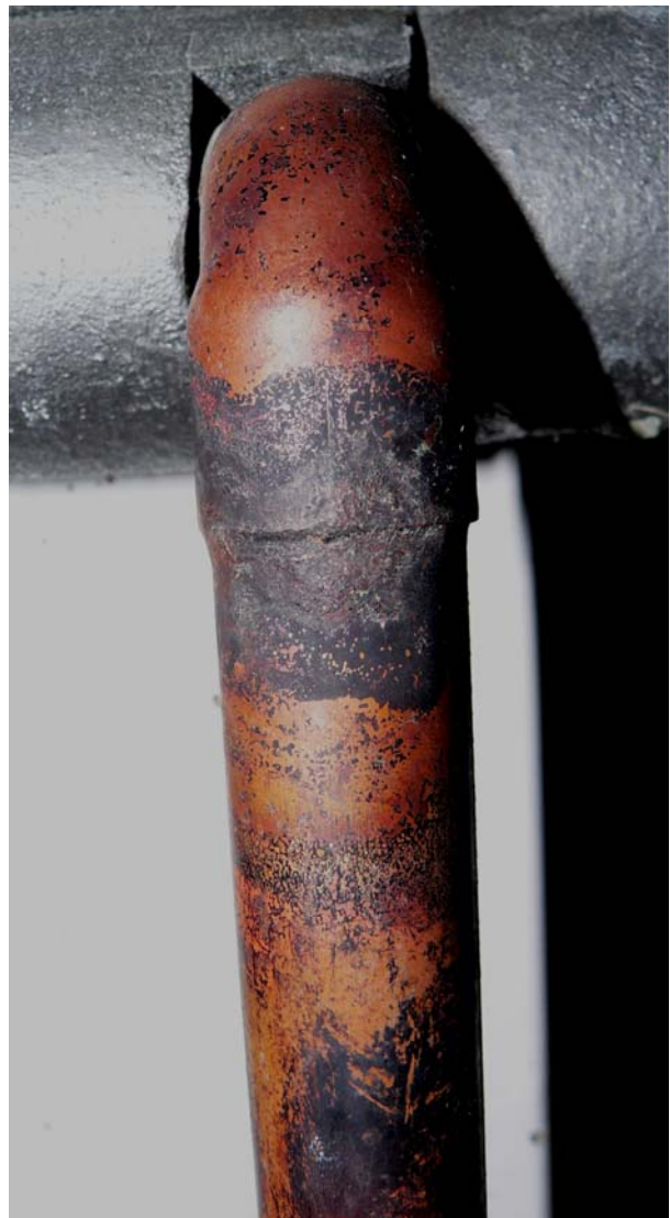
Bild 5.3.11 B: Lötstelle mit Hartlot, 30 Jahre alt
