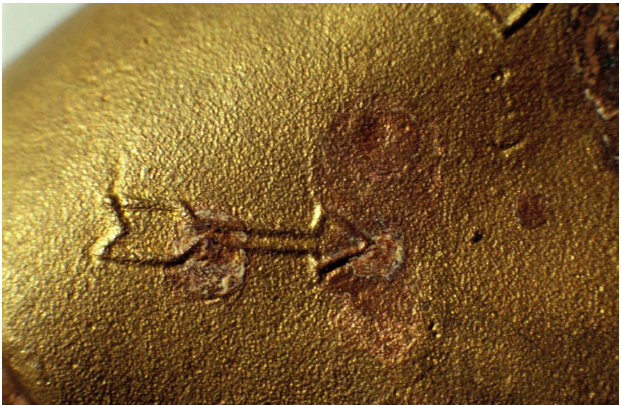
Bild 5.3.11 M: wie K, Nahaufnahme; die dunkleren Stellen sind an Zink verarmt und undicht.
