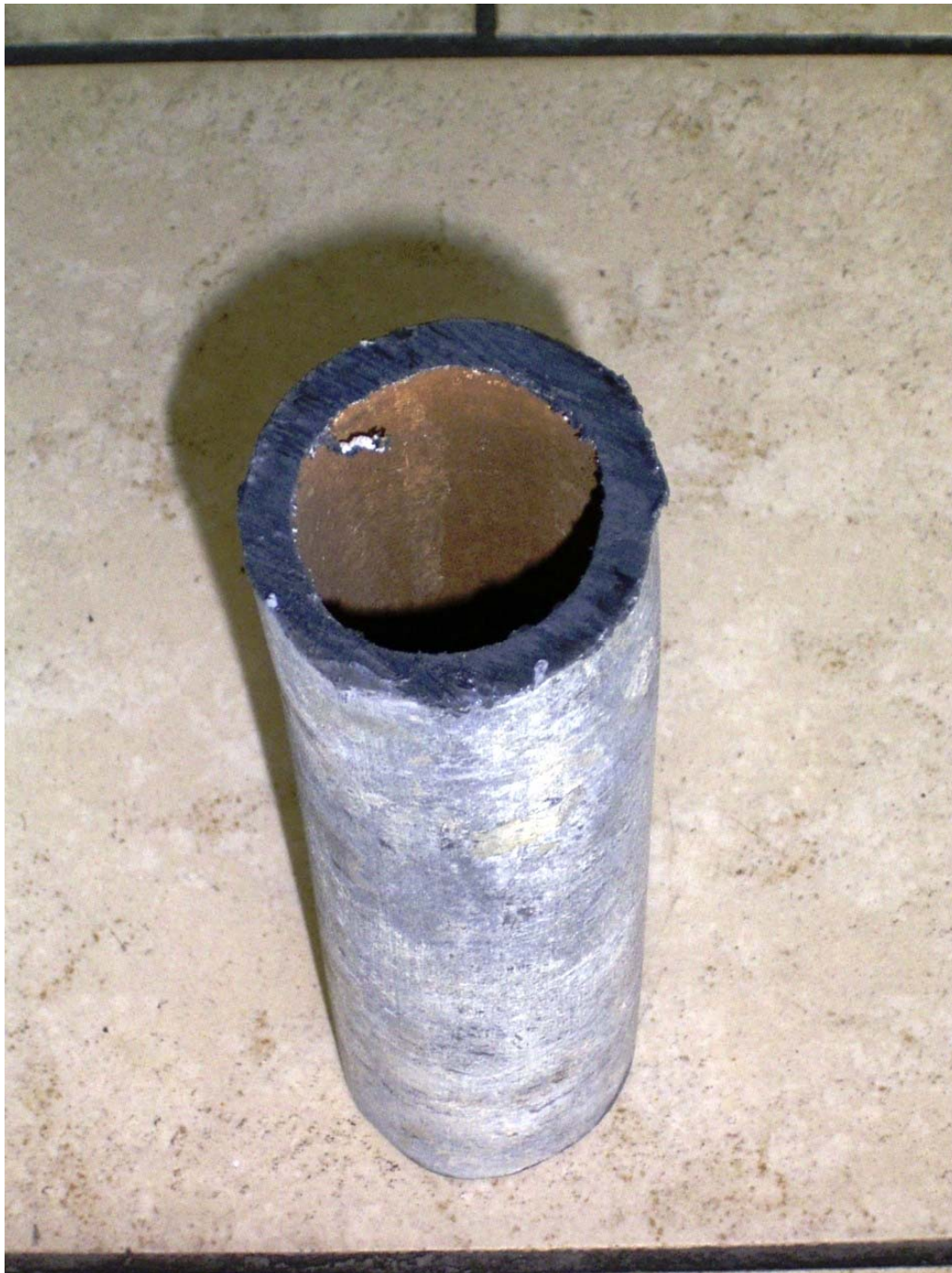
Bild 5.3.4 A: Alte Hausanschlussleitung DN 55 (mit Sägespan), Wandstärke: 8 mm
