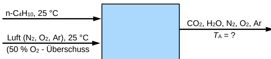
Abb.: Adiabatische Verbrennung von n-Butan (Grundfließbild zu diesem Beispiel)
