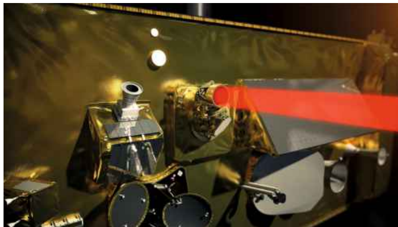
Die Laserterminals an Bord der EDRS-Satelliten entwickelte und baute das DLR. Sie ermöglichen die Übertragung von Daten in Echtzeit mit Raten bis zu 1,8 Gbit/s.
