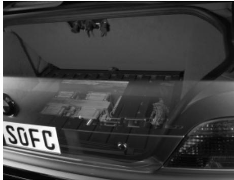
Abbildung 4.6: Hier hat die Brennstoffzelle bei BMW ihren Platz: als Stromlieferant für Klimaanlage, Beleuchtung und andere elektrische Verbraucher.
