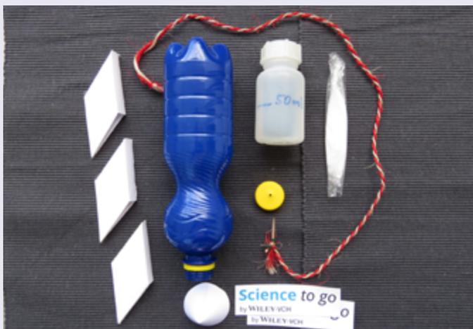
(2) Als **Raketentreibstoff** dient eine Mischung aus 10,6 g Natron und 50 ml Essigessenz (gibt's im Supermarkt; ihr könnt die 50 ml auch als 50 g abwägen, denn sowohl Wasser als auch Essigsäure besitzen eine Dichte von ziemlich genau 1 g/ml). Damit sich das Treibgas erst im Inneren der Rakete entwickelt, wickelt ihr das Natron in ein möglichst kleines Stück Frischhaltefolie ein (Achtung: das Paket muss noch durch den Flaschenhals passen).
